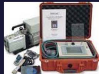
コンクリート透気性試験機パーマツール
