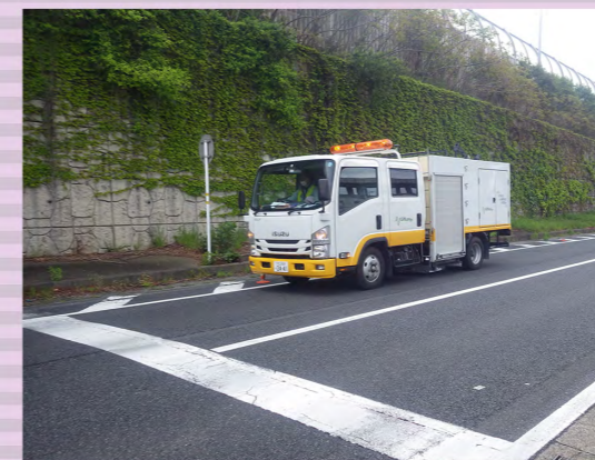
●路床空洞調査
